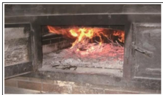
図9 原始的な直接燃焼式薪窯 (レンガ窯) (ドイツの小規模ビオベーカリーの一部では現在も使用されている)
