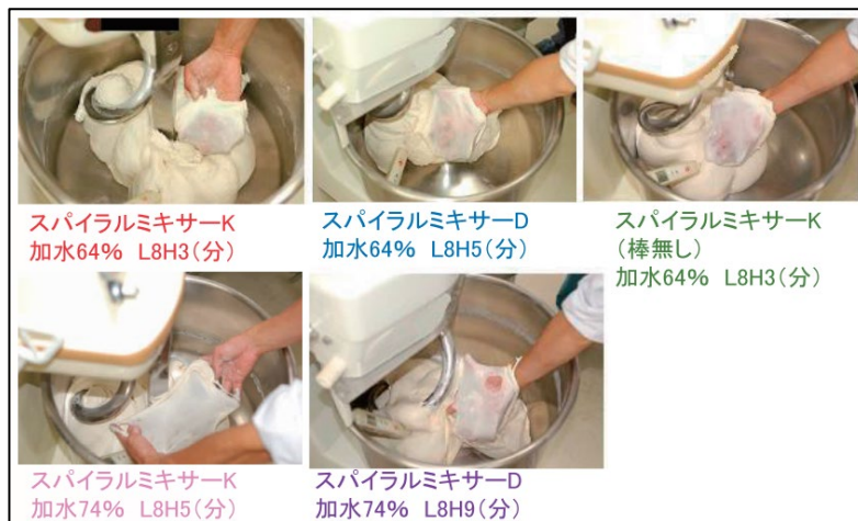
写真1. 2種類のスパイラルミキサー、2種類の加水条件における、食パン配合の捏上終了時の生地状態
