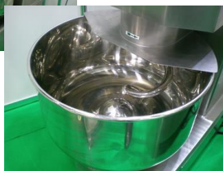
写真 1-2 試作したスパイラルミキサー (写真提供 関東混合器工業(株))
