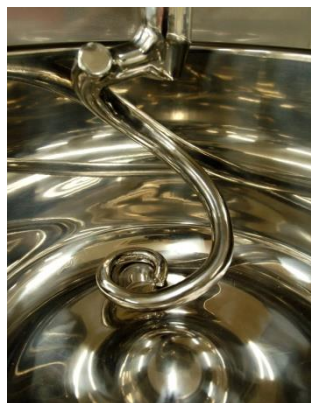
写真6 先端の曲りが大きい形状のアジテーター(試作品)
