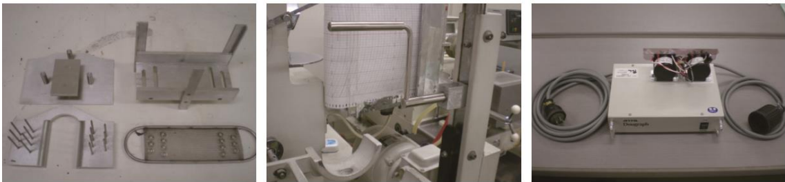
写真5 改良エクステンソグラフ(写真左、中)、改造ドウグラフ(写真右)
