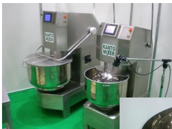
写真 1-2 試作したスパイラルミキサー (写真提供 関東混合器工業(株))
