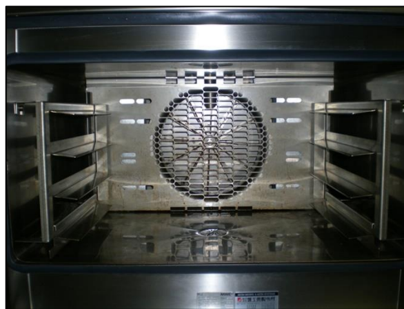
写真2 コンベクションオープンの炉室
