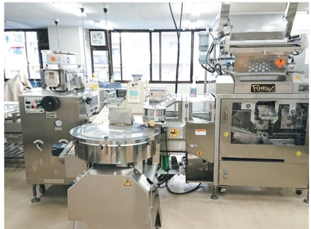
機械製パン実習で使用するストレスフリーデバイダー
